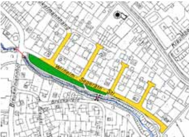
Abb. 4: Abgekoppelte Straßenflächen und Versickerungsbereiche Wilhelm-Segerath-Straße
