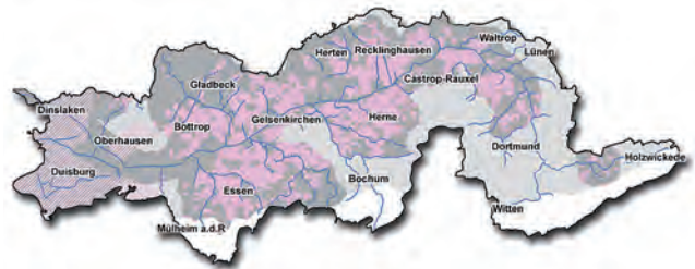
Bild 3: Dichte Kanäle können in großen Teilen der Region Grundwasseranstiege verursachen.
