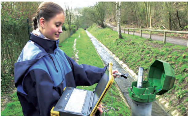
Bild 2: Ein dichtes Messnetz zu Grundwasserständen, Gewässerabflüssen und Klimadaten ist die Grundlage aller wasserwirtschaftlichen Modelle.
