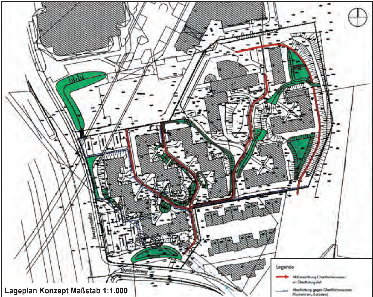
Bild 5: Konzept Regenentwässerung Studentendorf
