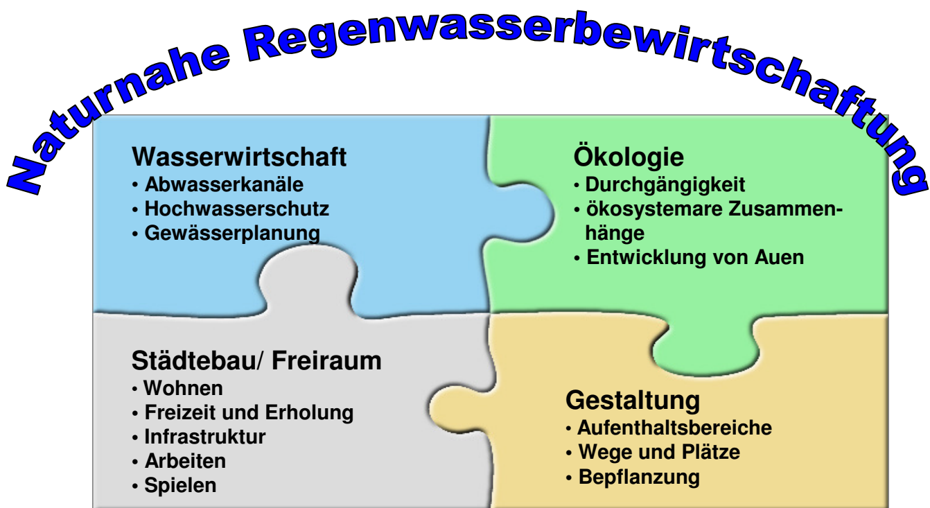
Abb. 5: Bausteine des Emscher-Umbaus mit dem „Dachthema“ Regenwasser
